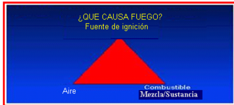
Figura 1.1 Condiciones para ignición
