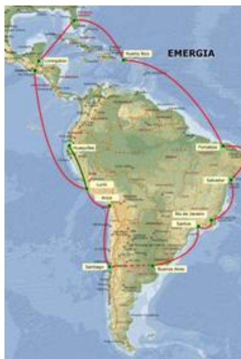
Figura 3.4 Cable de Telefónica (Emergia).
