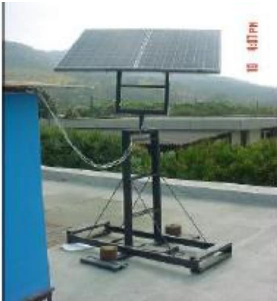
Este tiene la función principal de soportar mecánicamente a las celdas fotovoltaicas y de protegerlas de los efectos degradantes de la intemperie, por
