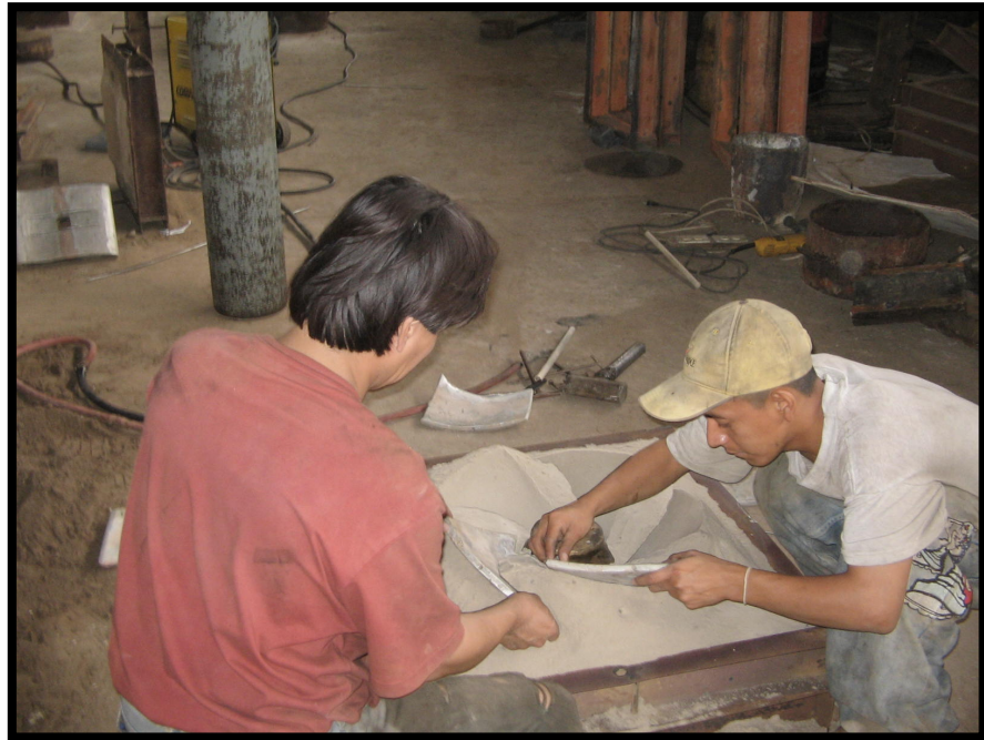
FIGURA 1.2 PROCESO DE ELABORACIÓN DE MOLDE EN ARENA DE SÍLICE/SILICATO DE SODIO/DÍÓXIDO DE CARBONO CO 2 .
