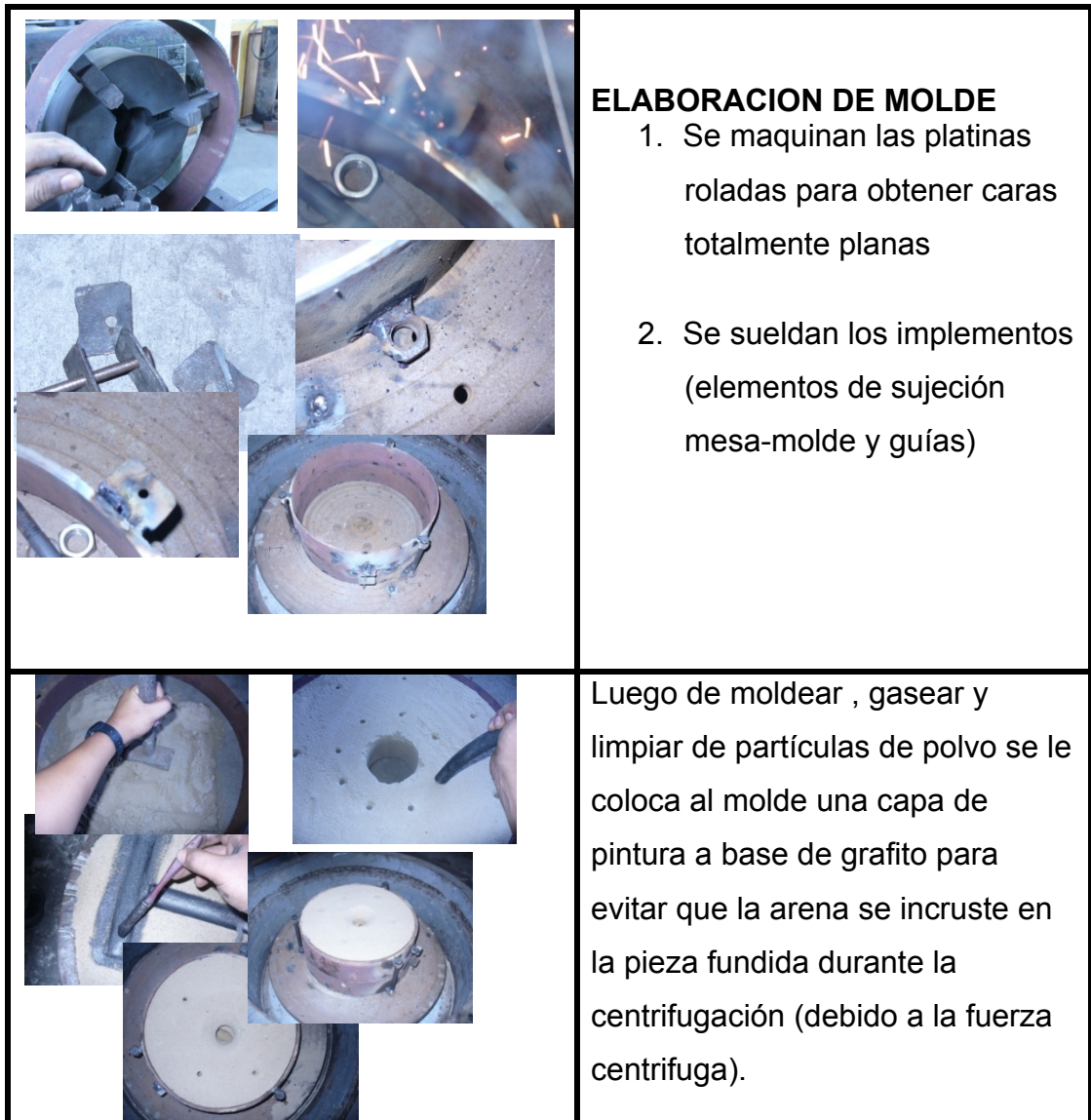
FIGURA 2.11 ELABORACIÓN DEL NUEVO MOLDE PARA ENSAYOS DE CENTRIFUGACIÓN.
