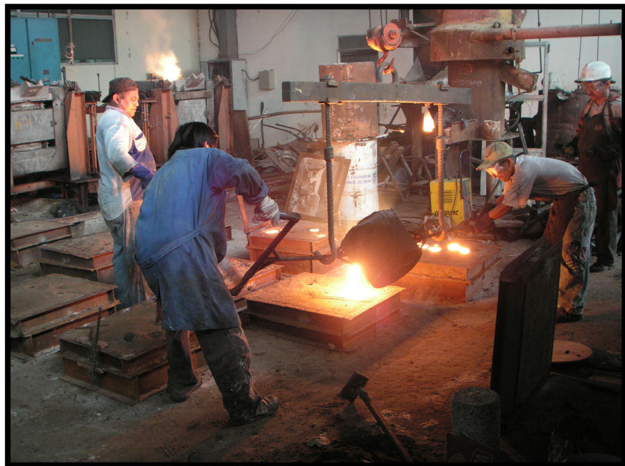
FIGURA 1.3 OPERACIÓN DE VERTER METAL FUNDIDO EN MOLDE DE ARENA O COLADO POR GRAVEDAD, G = 1.
