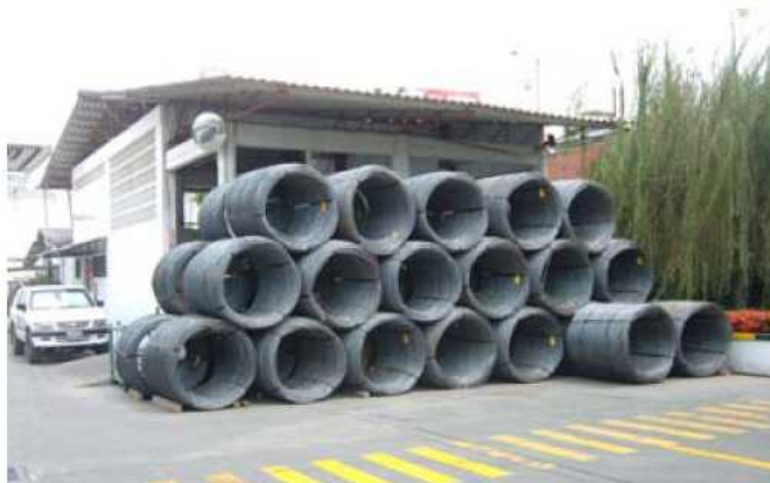
Figura 4.1 Almacenamiento de Alambrón
