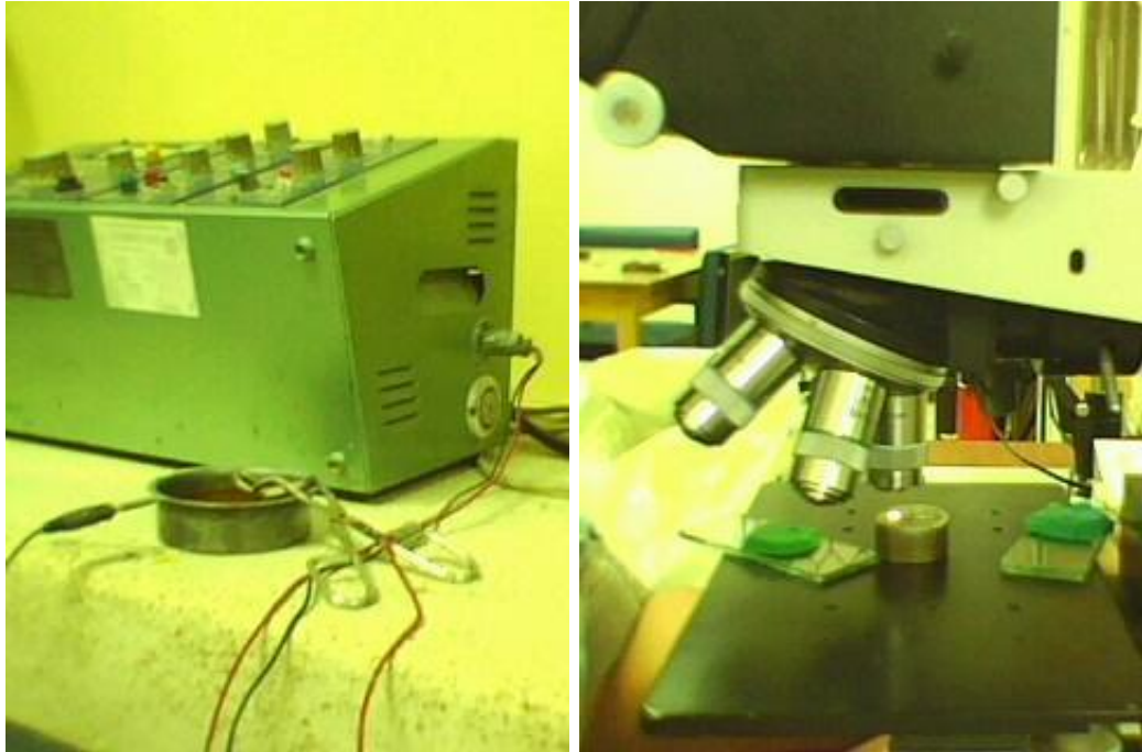
FIGURA 2.19. ATAQUE ELECTROQUÍMICO Y OBSERVACIÓN DE LA COLADA NORMALIZADA N° 7
