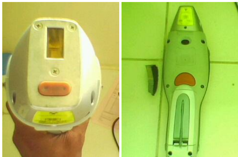
FIGURA 2.12. OPERACIÓN DE ANALIZADOR ÓPTICO POR RADIACIÓN, NITON xLi, PORTABLE XRF.
