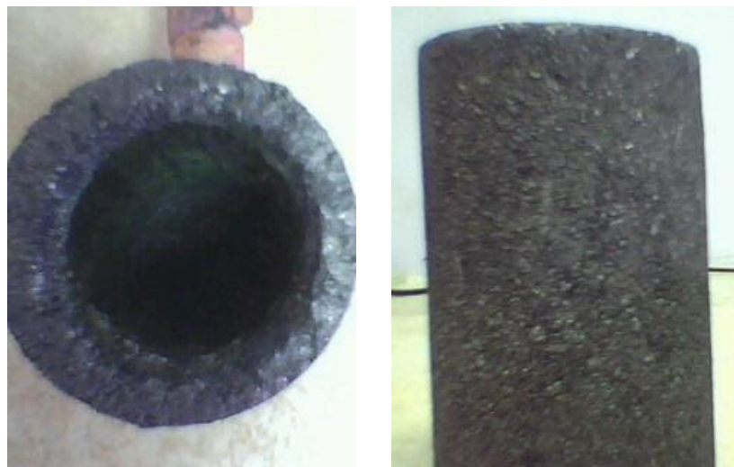
FIGURA 2.5. FISURAS EN EL MICROHORNO LUEGO DE 17 FUSIONES
