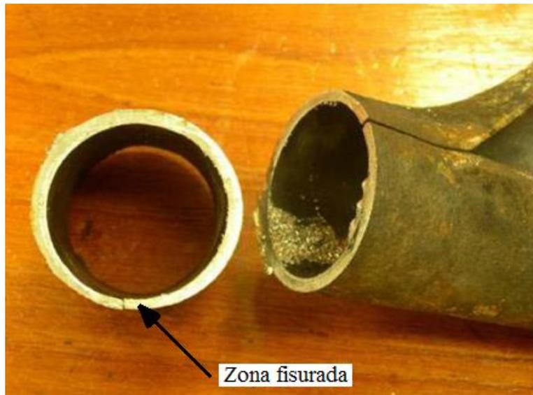
**Figura 1.22** DISMINUCIÓN DE ESPESOR EN ZONA FISURADA
