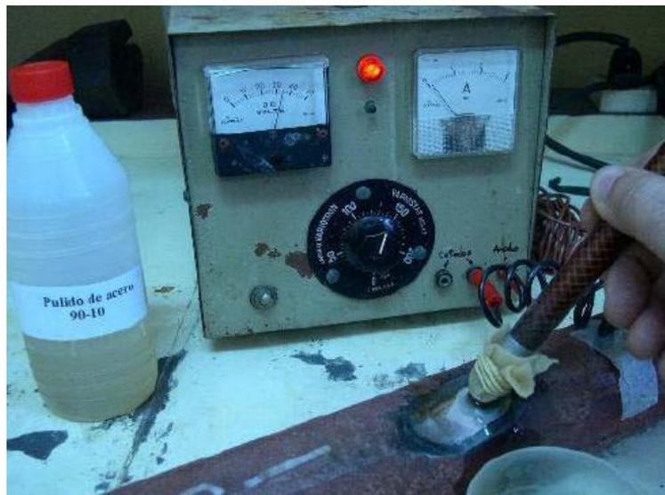
**Figura 1.34** FUENTE DE CORRIENTE CONTINUA PARA PULIDO ELECTROQUÍMICO.
