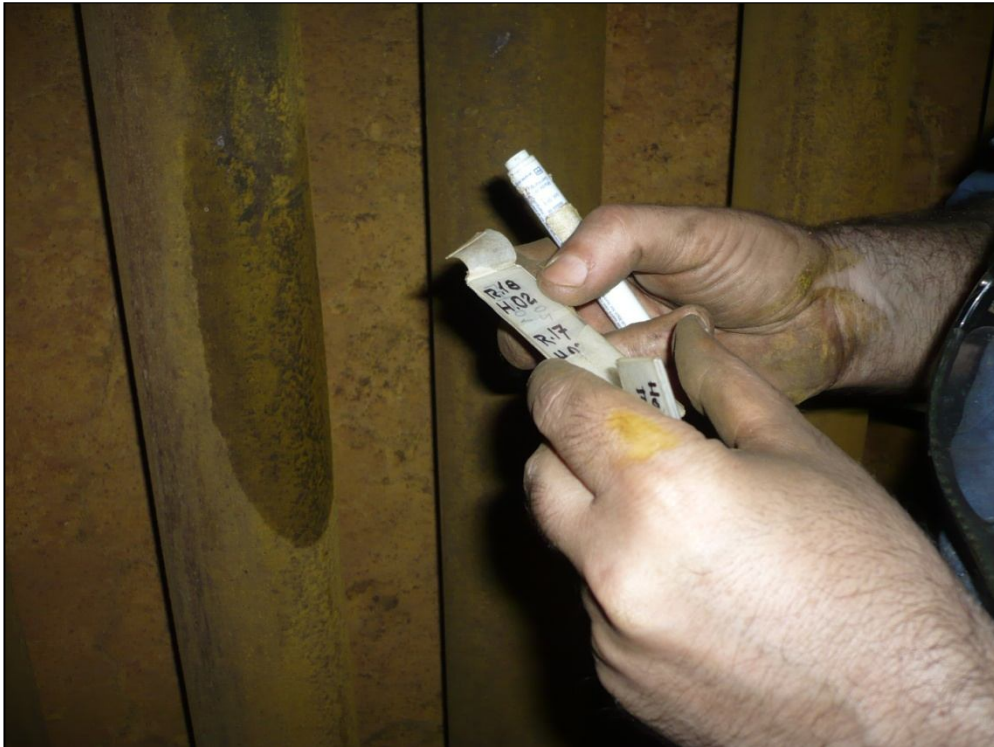
Figura 2.19 SE CLASIFICA LA RÉPLICA PARA SU TRANSPORTE Y POSTERIOR ANÁLISIS EN LABORATORIO
