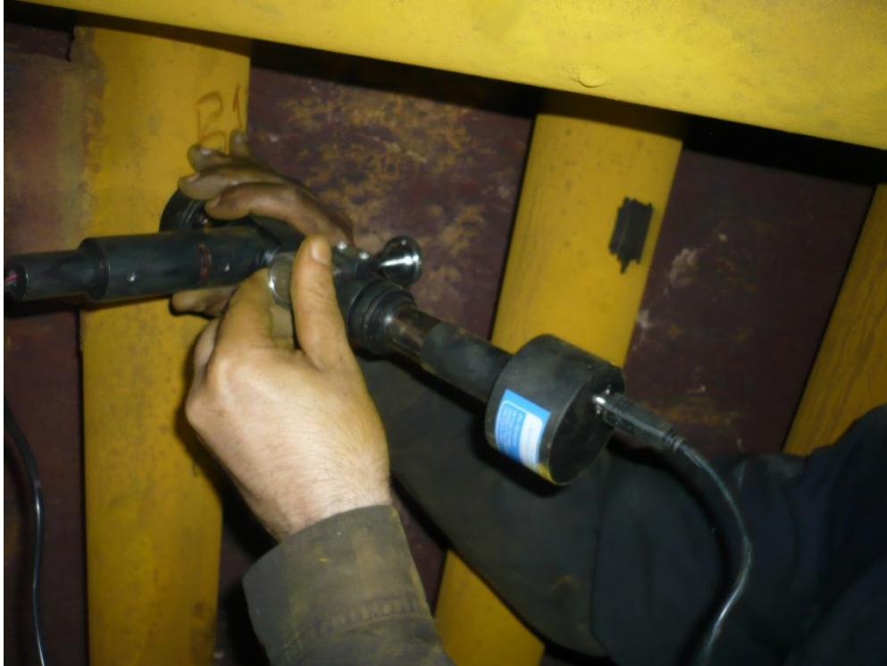
Figura 2.15 MANEJO DEL MICROSCOPIO HASTA OBTENER UN ENFOQUE PRECISO PARA LA DIGITALIZACIÓN DE LA MICRO ESTRUCTURA.
