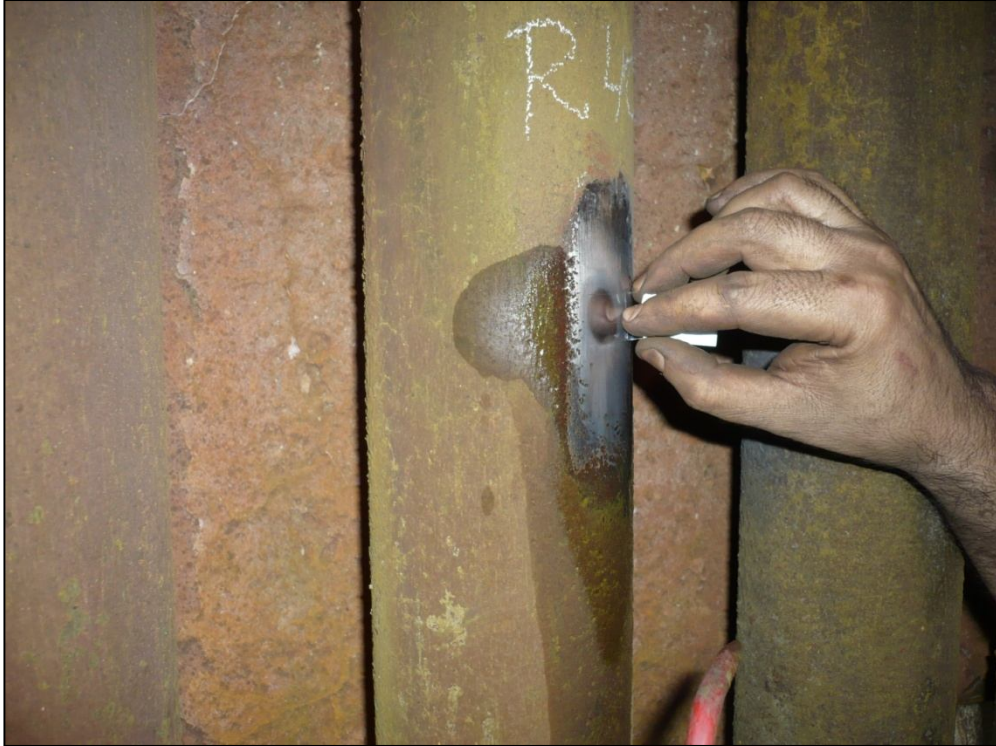
Figura 2.18 SE EXTRAE LA RÉPLICA DE LA SUPERFICIE LUEGO DE 5 MIN DE ESPERA. SE LO REALIZA CON LA MANO
