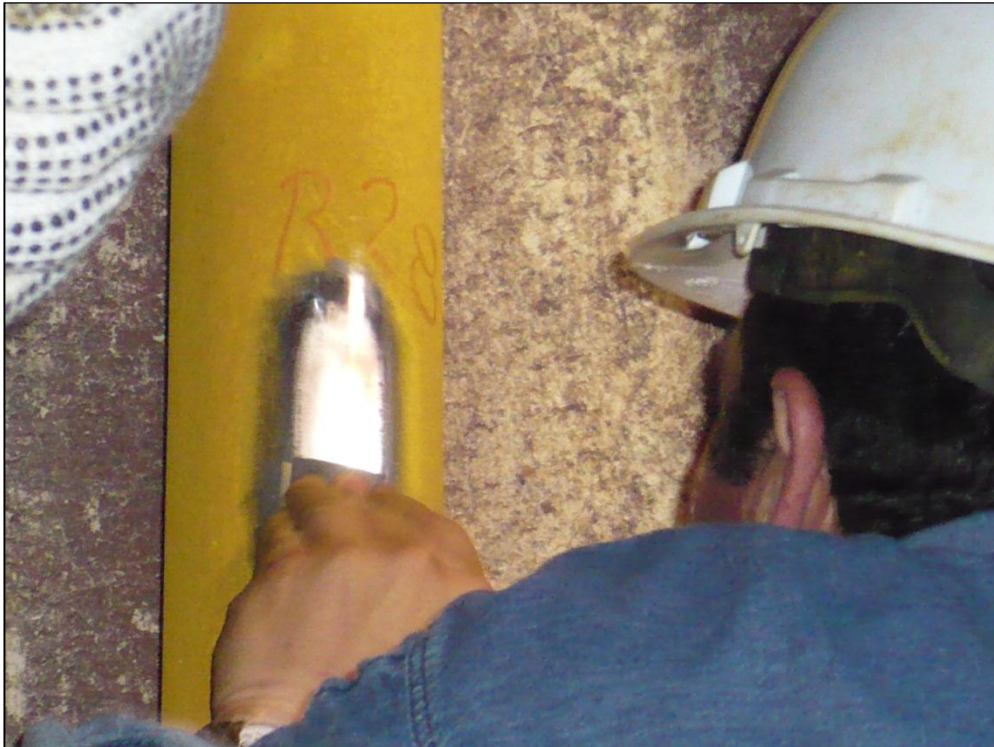
Figura 2.5 PULIDO MANUAL CON PAPELES DE GRANULOMETRÍA #400 Y 600
