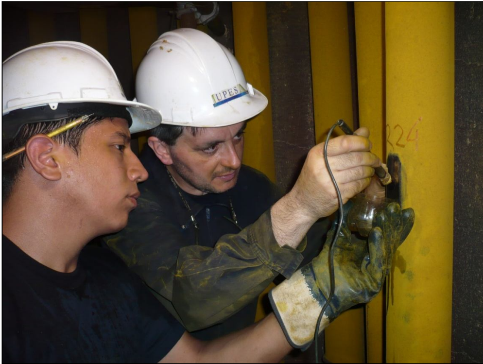
Figura 2.8 INICIO DEL PULIDO ELECTROLÍTICO, SE MOJA EL TAMPÓN EN EL ELECTROLITO
