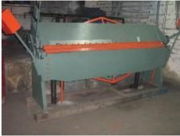
Fig. 3. - Doblado (Bending brake operation)
