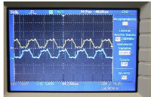
Figura 14. Fases de las bobinas del motor BLDC
