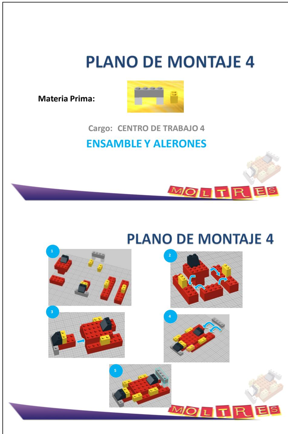
FIGURA 3.20. PLANO DE MONTAJE – CENTRO DE TRABAJO 4.
