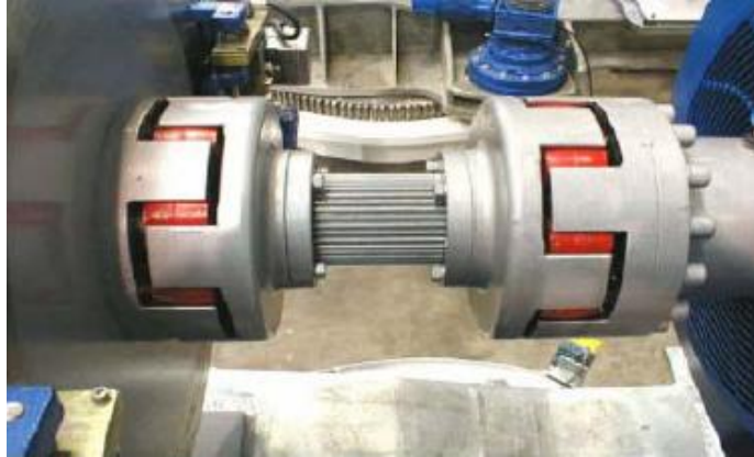
Gráfica No. 45 : Acoplamiento flexible a la salida de la caja multiplicadora
