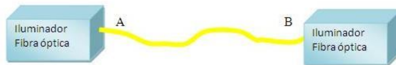
Figura 2.12: Forma de cómo se mide la intensidad de brillo lateral
