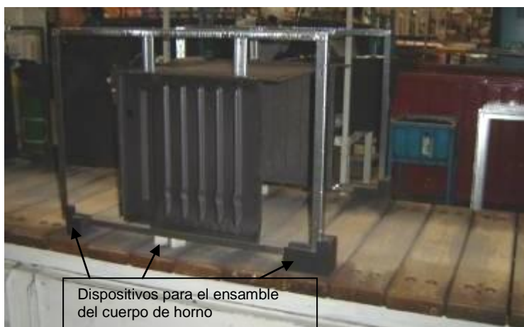
FIGURA 3.10 DISPOSITIVOS DE LA LÍNEA DE ALIMENTACIÓN DEL CUERPO DE HORNO DE LAS COCINAS DE 30".
