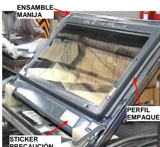
FIGURA 4.13, SUB-ESTACIÓN JALADERA Y PERFIL EMPAQUE
