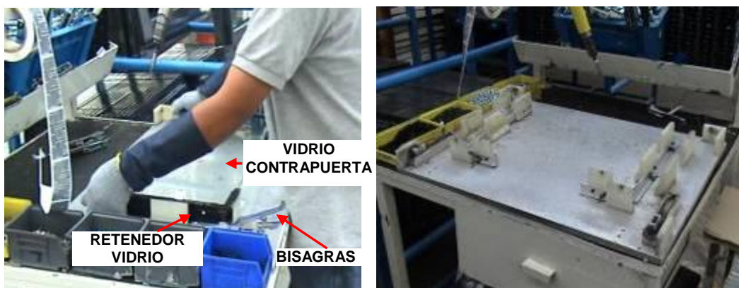
FIGURA 4.8 Y 4.9, SUB-ESTACIÓN CONTRAPUERTA DE HORNO
