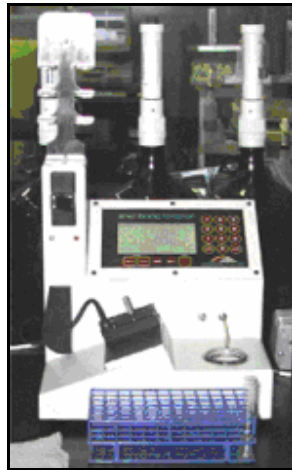
Figura 1.29 Equipo ISO 4406/1999 para Ferrografía Directa.
