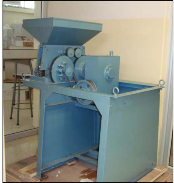
Maquina Briquetadora a motor
