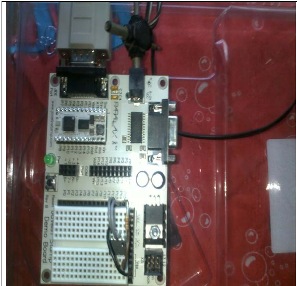
Figura 4.10 Ilustración de maqueta con módulo Javelin Stamp 3
