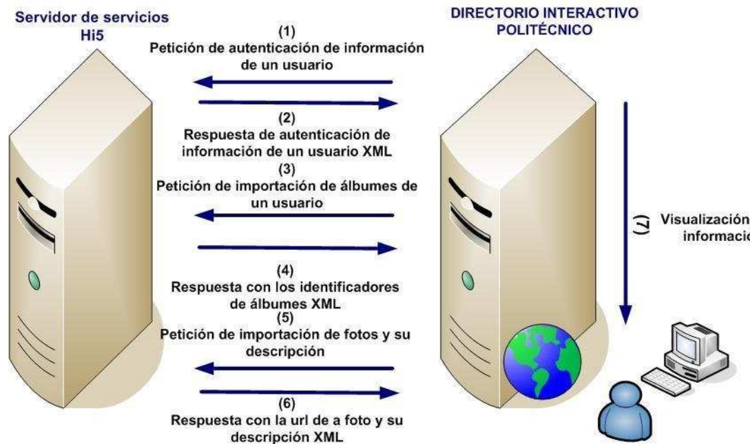
Figura 7.- Diagrama de comunicación REST con el servicio web de Hi5
