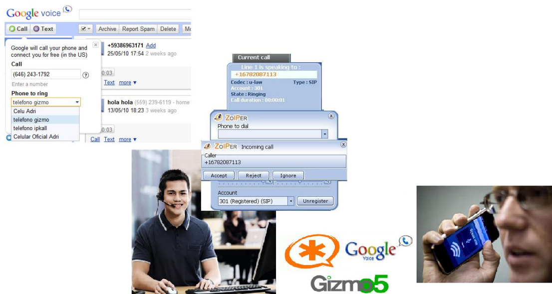
Figura 4.25: Llamada desde Google Voice redireccionada a una ext SIP hacia un Celular de EE.UU.
