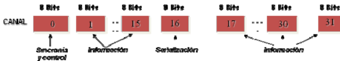
Figura 2.5 Estructura de la trama E1
