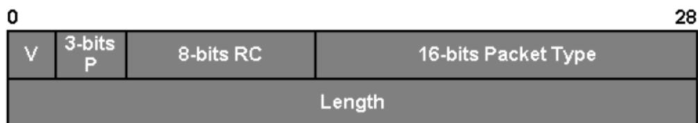
Fig. 2.11 Un paquete RTCP con sus cinco campos de cabecera
