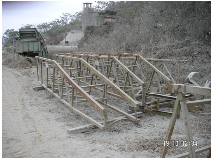
FIGURA 4.1. ARMADURA DE TRANSPORTADORES
