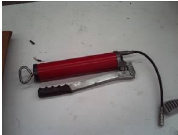
FIGURA 4.5 HERRAMIENTA DE LUBRICACIÓN BOMBA DE GRASA MANUAL.
