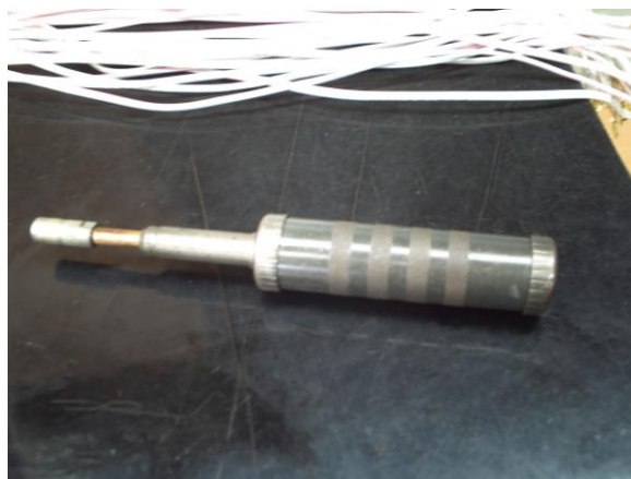
FIGURA 4.6 HERRAMIENTA DE LUBRICACIÓN ACEITERA MANUAL.
