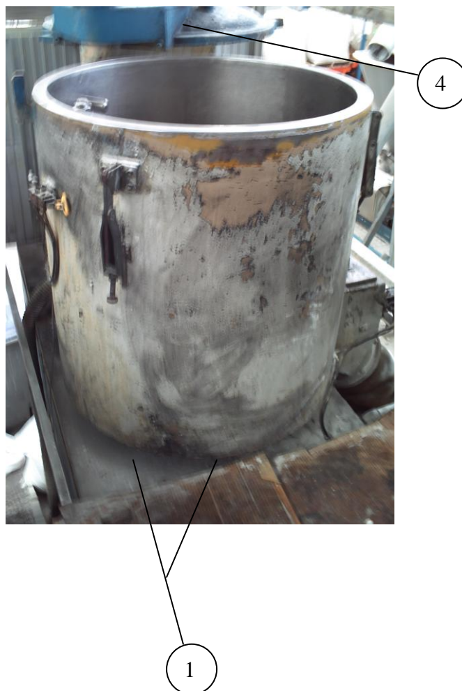
PUNTOS DE LUBRICACIÓN MÁQUINA TURBOMEZCLADOR 1. FIGURA 1/2.
