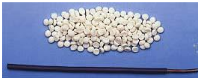
FIGURA 1.2 PVC 50/80 NATURAL-NEGRO-BLANCO PARA RECUBRIMIENTO DE CABLE ELÉCTRICO.
