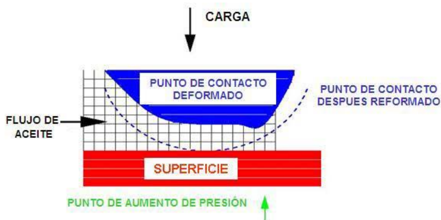
FIGURA 2.4 ESQUEMA DE LUBRICACIÓN ELASTOHIDRODINÁMICA.
