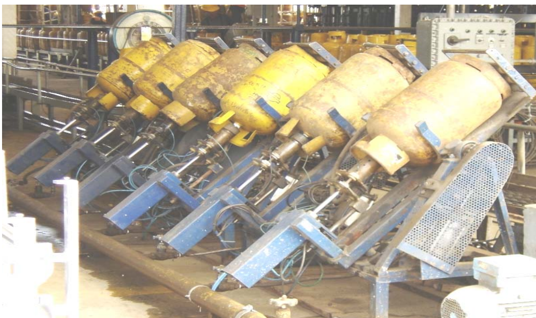
FIGURA 3.7 MÁQUINA VOLTEADORA DE CILINDROS LLENOS CON FUGAS PARA EVACUACIÓN DE GLP LÍQUIDO
