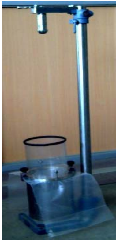
Figura 2.12 MÁQUINA DE IMPACTO AL DARDO
