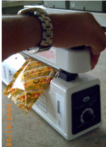
Figura 2.6 SELLADO DE POUCHES
