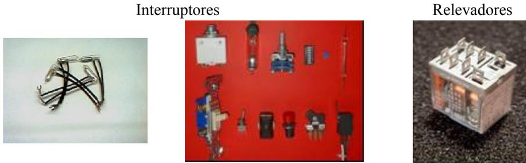
Figura 5.10. Interruptores y reveladores que contienen mercurio
