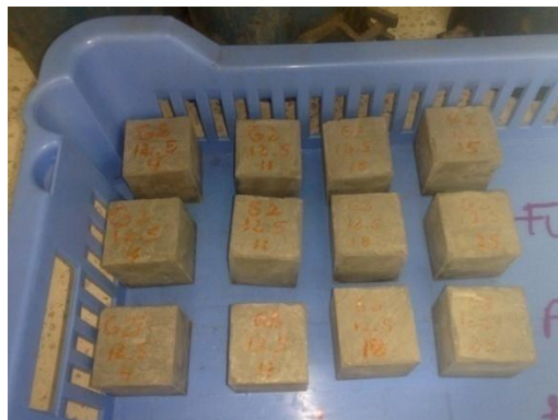
DESMOLDADO Y PROCESO DE CURADO
