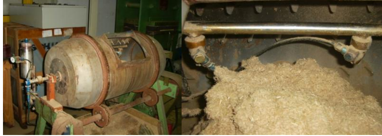
FIGURA 4.2 TAMBOR ROTATORIO. VISTA EXTERIOR E INTERIOR
