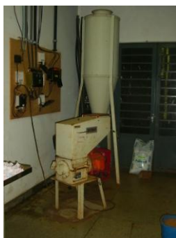
FIGURA 4.1 MOLINO SEIBT, TIPO WILEY
