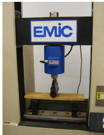
FIGURA 5.1 MÁQUINA DE ENSAYOS UNIVERSALES ENSAYANDO PROBETA
