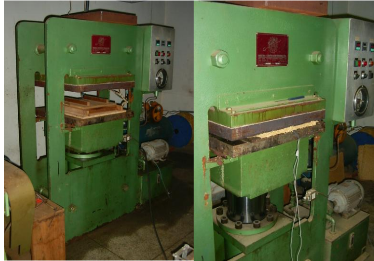
FIGURA 4.5 PRENSADO. FORMACIÓN DEL TABLERO
