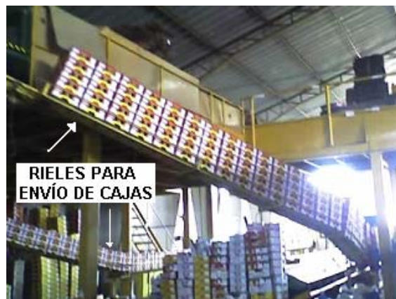
FIGURA 5.2 RIELES PARA ENVÍO DE CAJAS A LAS LÍNEAS DE EMPACADO PARA EUROPA
