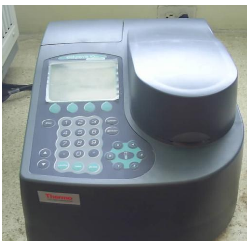
FIGURA 3.3 EQUIPO PARA ENSAYOS DE TRANSMITANCIA
