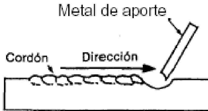
FIGURA 2.11 SOLDADURA DE CORDÓN (Ref. 4)
