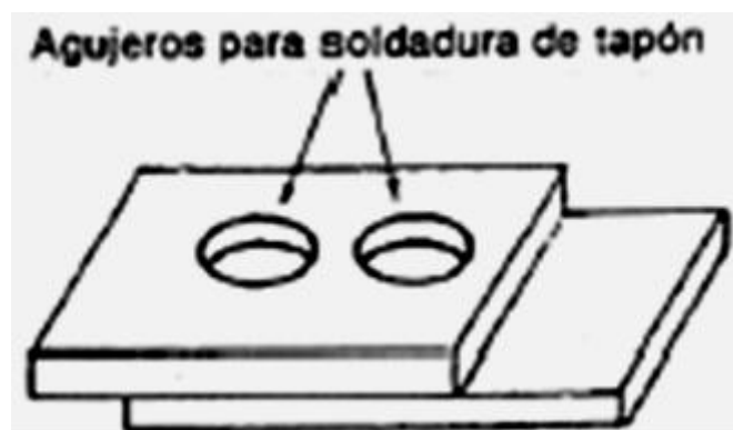
FIGURA 2.13 SOLDADURA DE FILETE (Ref. 4)
