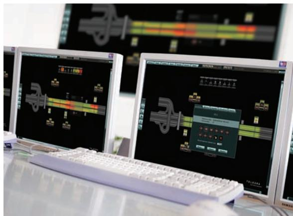
**Sistemas de Pesaje en Movimiento – WIM (Weigh in Motion)** Recibe datos en tiempo real emitidos desde equipos WIM en el campo y registra el peso del tráfico de camiones e información de sus credenciales
