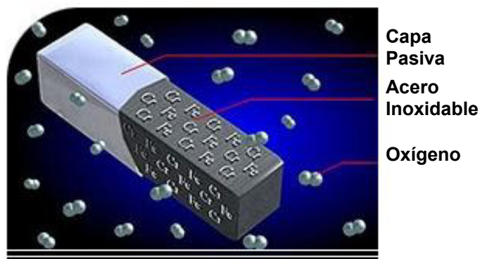
FIGURA 4.7. COMPONENTES DEL ACERO INOXIDABLE
