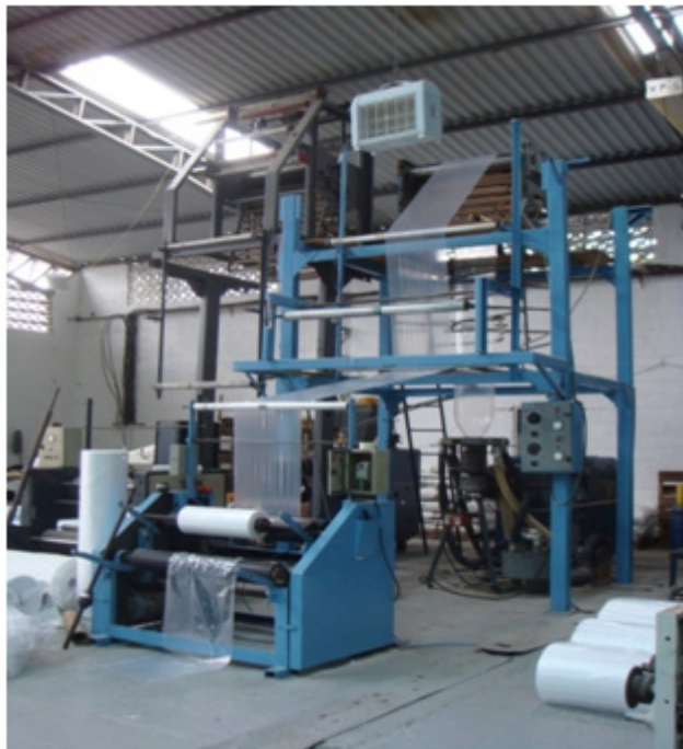
FIGURA 3. 2. EXTRUSIÓN DE PELÍCULA DE POLIETILENO
