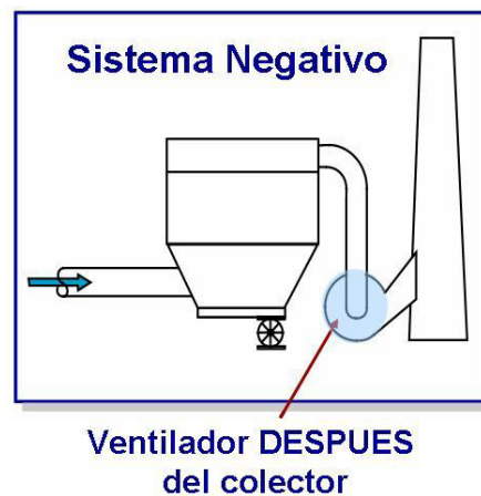
FIGURA 2.10. SISTEMA DE PRESIÓN NEGATIVA
