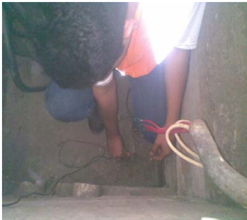
Fig. D. 1 Conexión del equipo al electrodo del cuarto de transformadores y al área de oficinas
