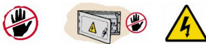
Fig. 7 a) Prohibido Tocar b) Equipo Energizado c) Peligro de Electricidad
