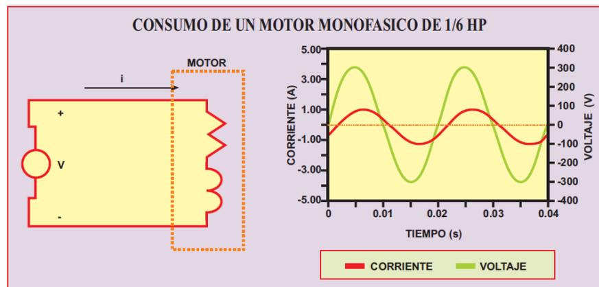
Figura 2.2. Consumo de un motor monofásico de 1/6 HP
