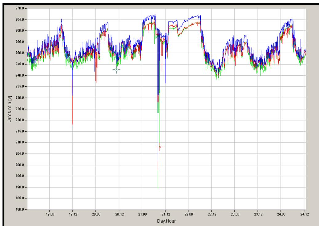
Figura 5.1 Espectro de Voltaje mínimos Diciembre 2008 BLOQCIM S.A.
