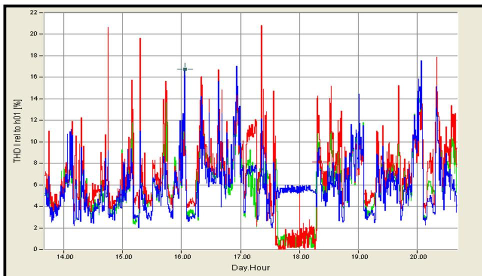
Figura 5.25. Espectro de Distorsión Armónica Total de Corriente de la medición Enero 2010 BLOQCIM S.A.
