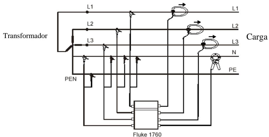
Figura 4.3.- Conexión Trifásica del Analizador de Energía
