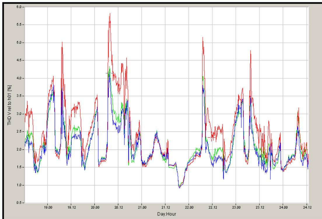
Figura 5.20. Espectro de Distorsión Armónica Total de Voltaje de la medición
