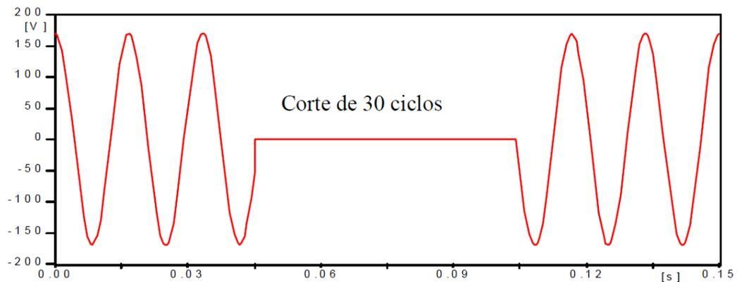
Figura 2.4. Interrupción típica de una onda de tensión
