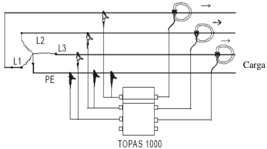
Figura 4.2.- Conexión Trifásica del Analizador de Energía
