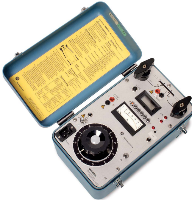
Fig 18. Microhmetro modelo MOM600A
