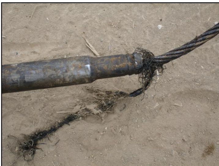
FIGURA 2.12 RUPTURA EN LA UNIÓN CABLE-HERRAMIENTA LOCAL
