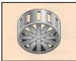
FIGURA 3.13 CESTA PARA DESPERDICIOS EN EL FONDO DEL POZO
