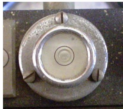
**Figura 3.17** Visor de nivelación del Viscosímetro.
