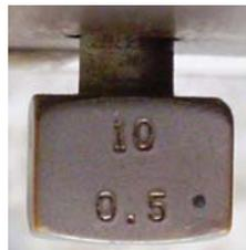
**Figura 3.19 Selector de velocidades del Viscosímetro.**
