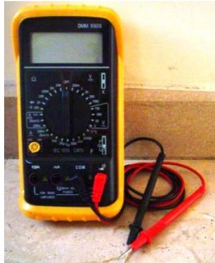
**Figura 3.16 Multímetro.**
