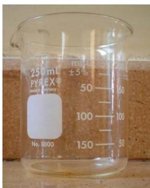
**Figura 3.6 Vaso de precipitación Pyrex.**
