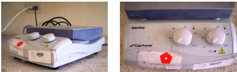
**Figura 3.15 Agitador Magnético – Calentador.**
