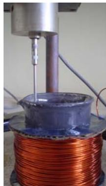
**Figura 3.24 Colocación del spindle dentro del FMR.**
