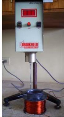
**Figura 3.23 Colocación del FMR en el Viscosímetro.**
