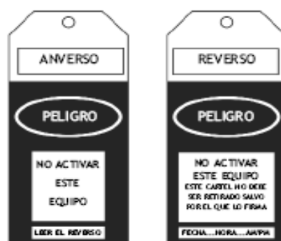
Fig. 5.3. Letreros de señalización indicando la prohibición de conectar. (Fuente: Guía Técnica para la Evaluación y Prevención de Riesgo Eléctrico)
