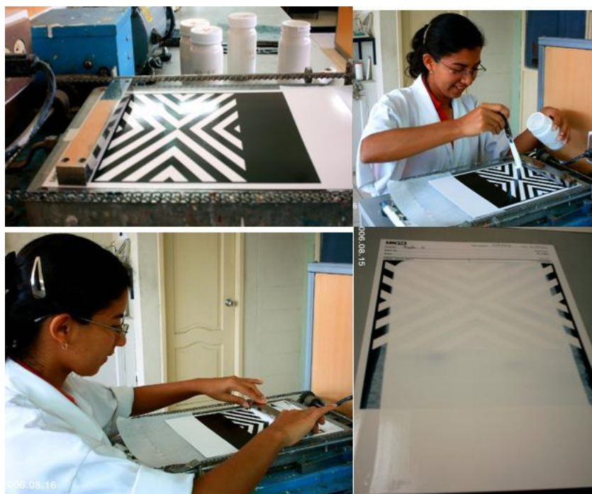
FIGURA 3.12. Preparación de Películas de pinturas.
