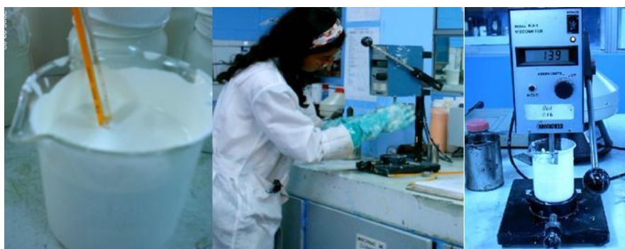
FIGURA 3.20: Medición de viscosidad
