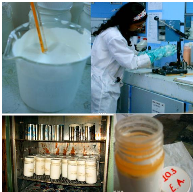
FIGURA 3.15. Proceso de preparación de Prueba de Estabilidad Acelerada
