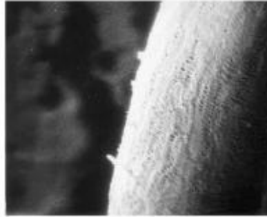
FIGURA 2.13: SEM de fibra de aceite de palma tratada con acetileno (x200) (109).
