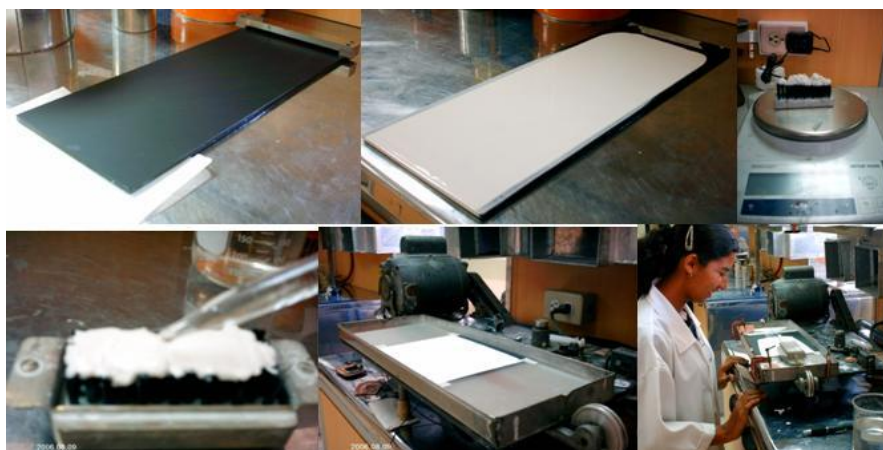
FIGURA 3.14: Proceso de Preparación de la Prueba de Abrasión
