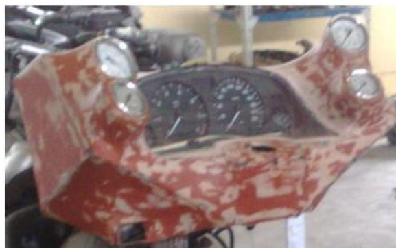
Figura 2.14 Recubrimiento con masilla de la protección del tablero
