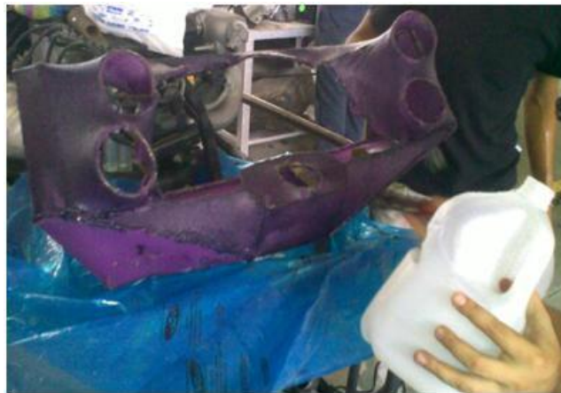
Figura 2.12 Recubrimiento con resina de la protección del tablero
