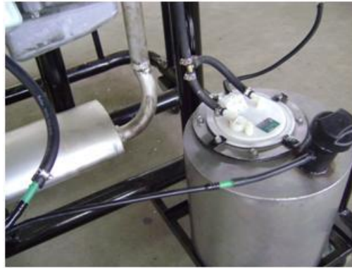
Figura 2.9 Tanque de combustible
