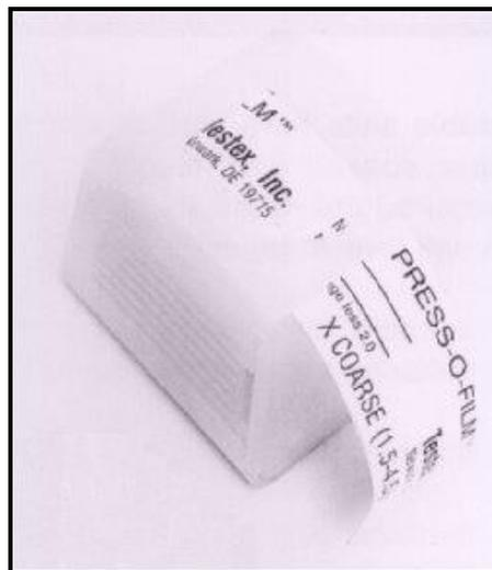
**Figura # 2.21 "CINTA DE MEDICIÓN DE RUGOSIDAD"**
