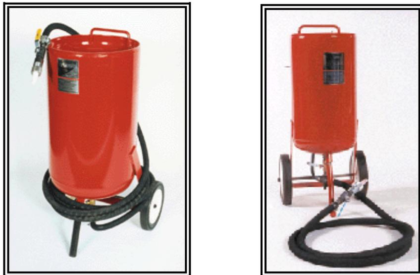
**Figura # 2.16 "MAQUINAS DE CHORREADO ABRASIVO"**
