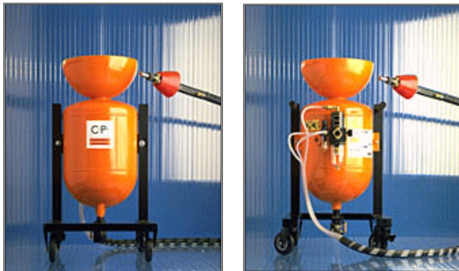
**Figura # 2.4 "VISTA FRONTAL Y POSTERIOR DE EQUIPO DE SANBLASTING"**
