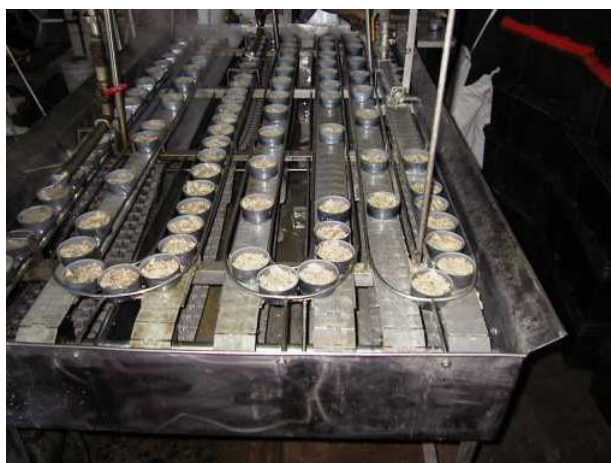
Fig. 15 Adición de líquido de cobertura
