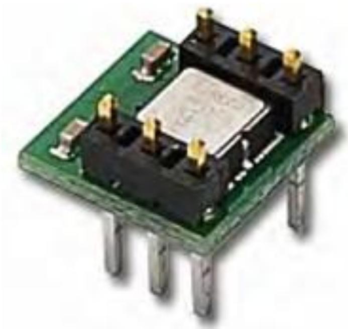
El acelerómetro MX2125 de Memsic está basado en 2 ejes. Es capaz de medir ángulos de giro, colisiones, aceleración, rotación y vibraciones en un rango de hasta  $\pm 3$  g sobre los dos ejes X e Y.
