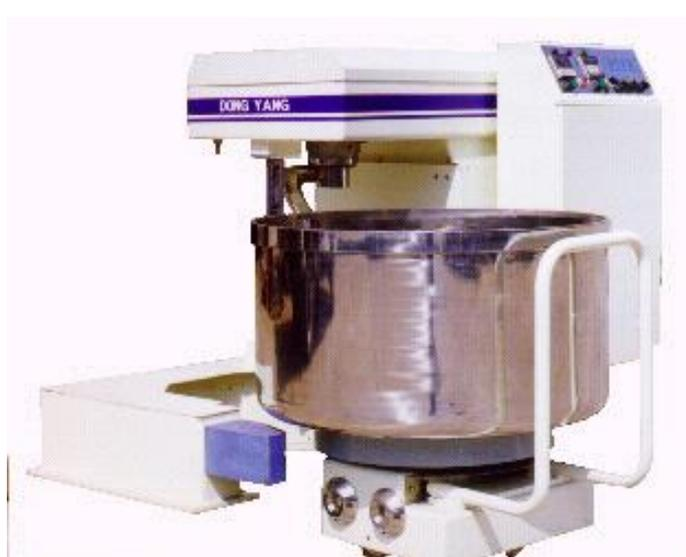
Fig. 1.2. Ejemplo de mezcladora de espas verticales.
