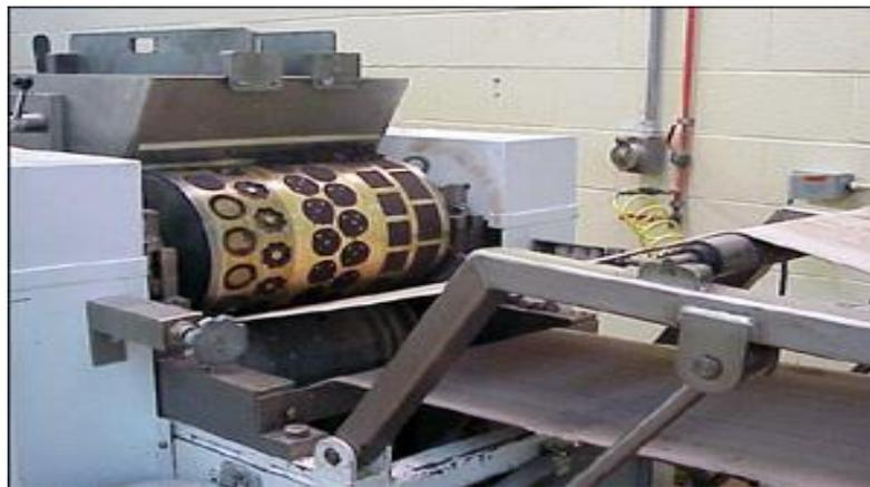
Fig. 1.4. Ejemplo de una moldeadora rotatoria.
