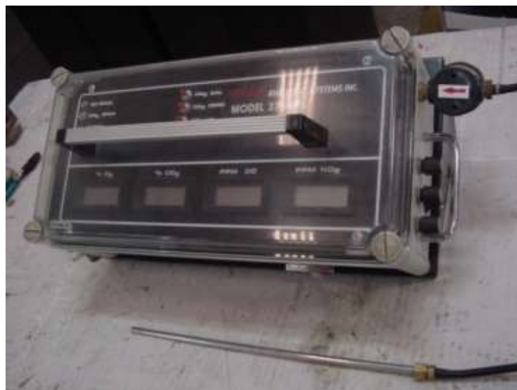
FIGURA 3.7 ANALIZADOR DE GASES
